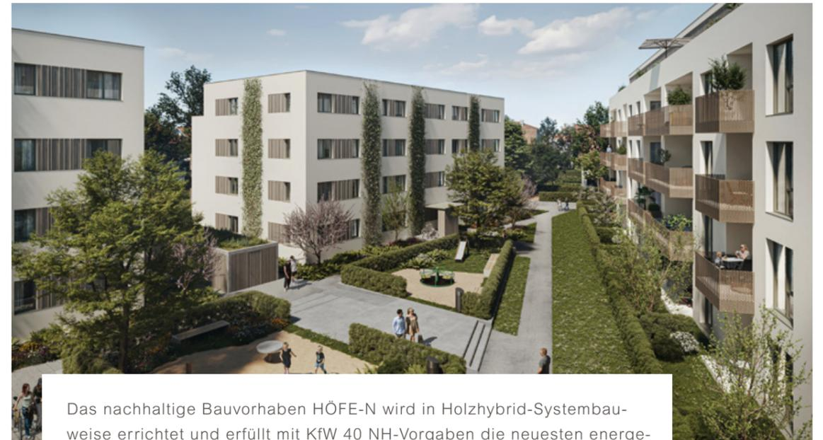
Das nachhaltige Bauvorhaben HÖFE-N wird in Holzhybrid-Systembauweise errichtet und erfüllt mit KfW 40 NH-Vorgaben die neuesten energetischen Standards. Mittels Photovoltaikanlage, Wärmepumpe und Pelletheizung wird eine CO<sub>2</sub>-neutrale, weitgehend autarke Energieversorgung erreicht. Aufgrund der Bahnähe wurde das Gebäude mit Erschütterungsmatten entlang den Bahngleisen versehen.
